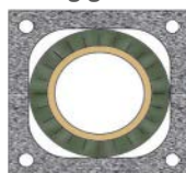
objektivHausschornstein System Einzügig
